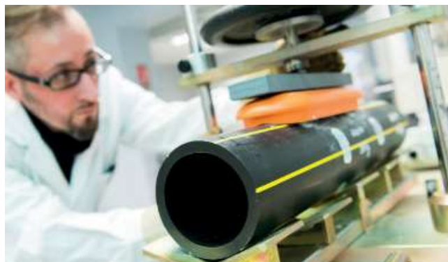
Réalisation d'un essai sur un tube PE (polyéthylène) équipé d'un boîtier RFID dans le laboratoire de caractérisation mécanique des polymères
